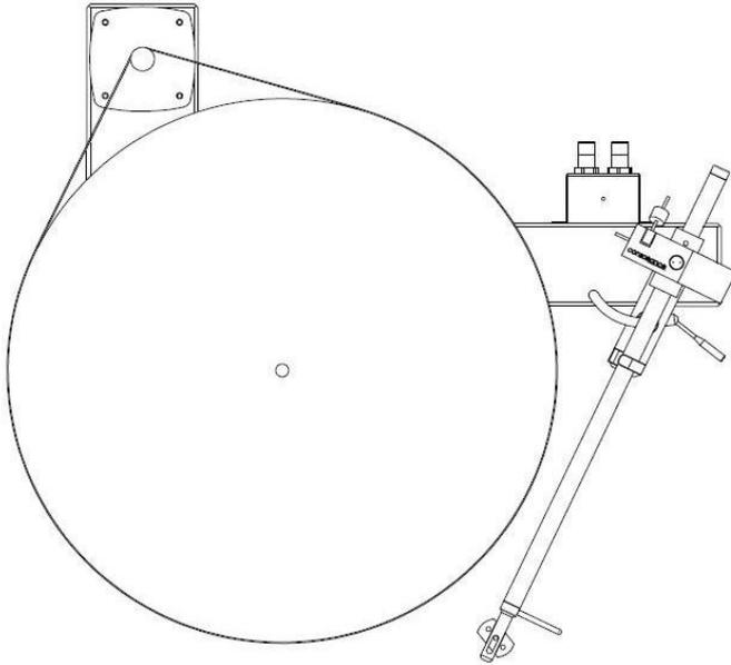
4. 马达上的滑轮有两个槽，由上而下分别是 45 转/分和 33.3 转/分的速度选择槽，当传送带（鱼线）装在不同速度槽上时，唱盘转速分别是 45 转/分和 33.3 转/分。
