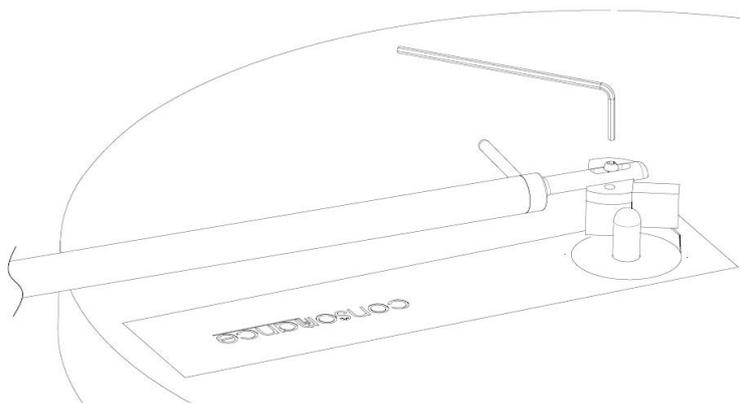
3. 将配重安装在唱臂的后部，通过轻轻旋转配重来设置唱针的压力，使用提供的测力计，按照唱头制造商的推荐，施加正确的唱针压力。
