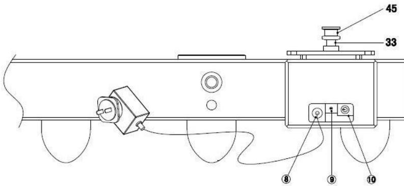
5. 测速盘放在转盘上，在白炽灯泡的照射下，轻轻调节速度电位器（部件号 9）配合配合测速卡，以获得正确的速度。
