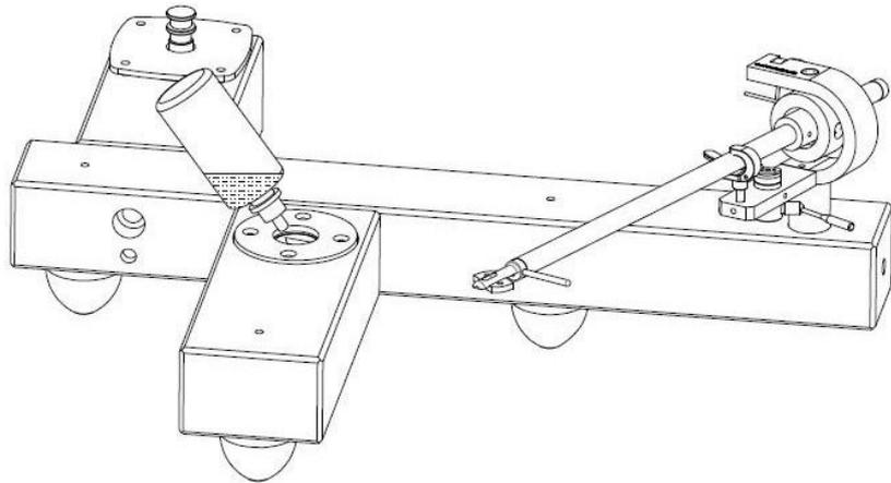
3. 将亚克力转盘取出，轻轻地套入轴套中，确认平稳顺畅，并且可按惯性转动。装传动带（鱼线），绕过转盘与马达上的滑轮连接好。
