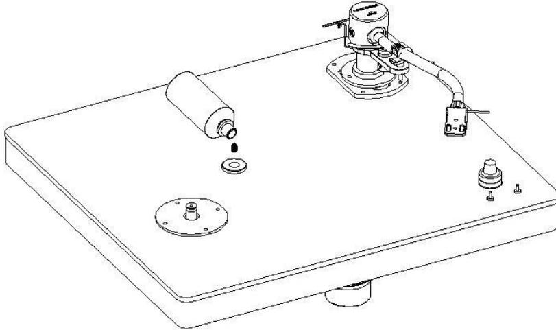
2. 将亚克力主动轮取出，平稳放入顶盖上的轴套内，确认平稳顺畅，并且可按惯性转动。
