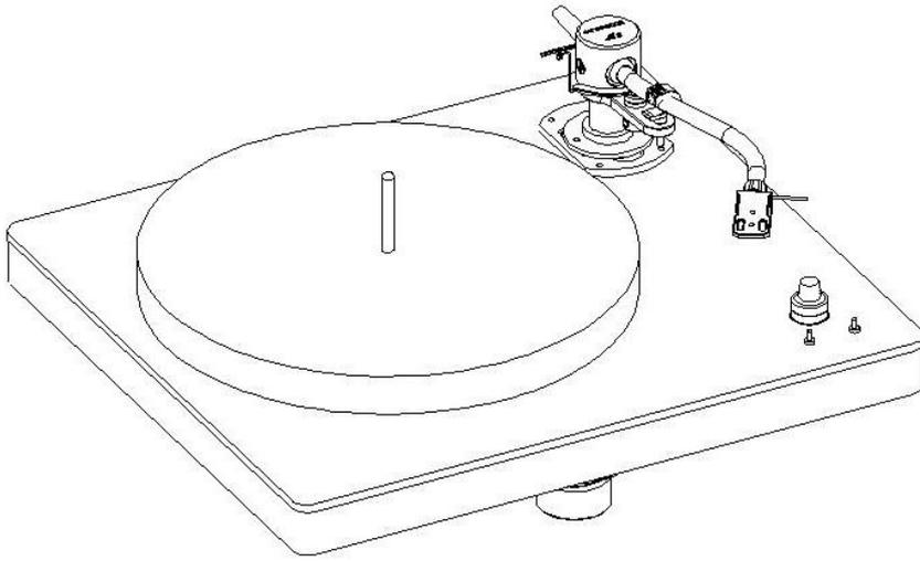
4. 连接电源，利用速度调节旋钮可以精确调整直流马达速度。调整时用自带的测速卡，采用白炽灯观看。测速卡上根据不同的地区分为 50Hz 与 60Hz，转速分别为 33.3 转/分与 45 转/分两种，当测速卡黑杠停在同一位置上，说明唱盘转速正确。
