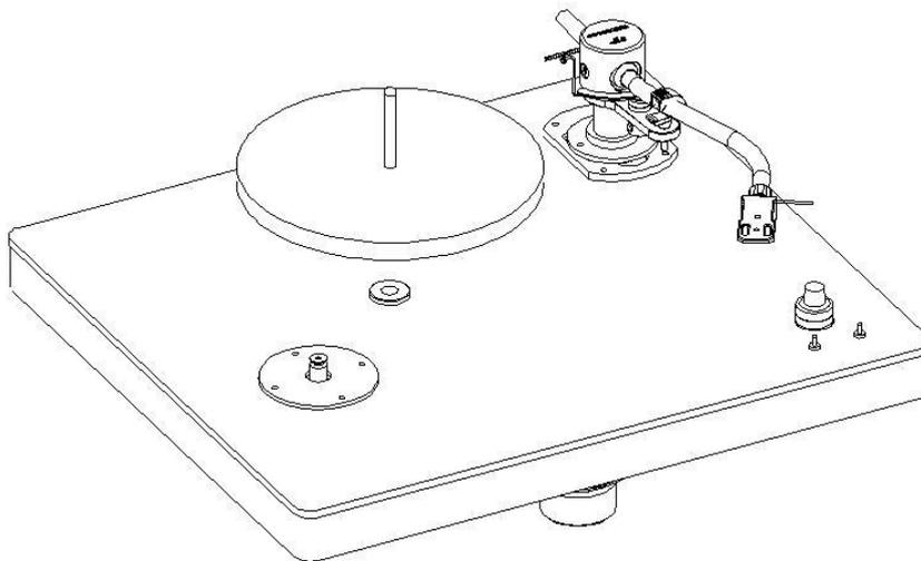
3. 将传送带绕过主动轮与马达上的转轮连接好，并将转盘依次顺轴承杆放上。
