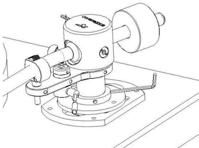
7. 安装调节好唱头和唱臂后，可用水平仪检查底盘是否水平，如果不够水平，可以通过调整地脚顶部来达到要求。
