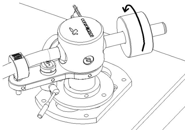
6. 用扳手松开侧面的顶丝，可以进行唱臂的 VTA 调节，待调节合适后再锁紧顶丝。
